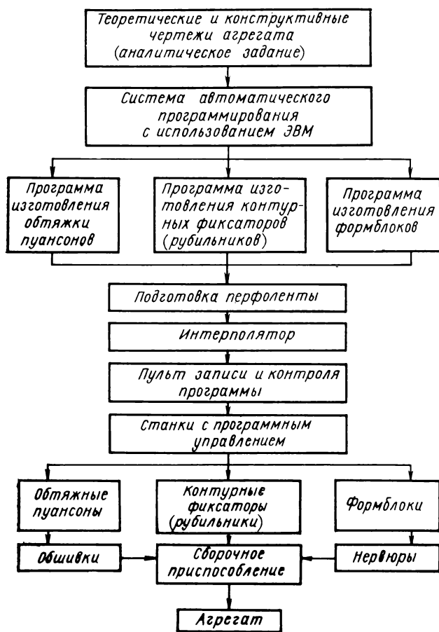
Рис. 92. Схема увязки размеров оснастки при независимом изготовлении на станках с программным управлением
